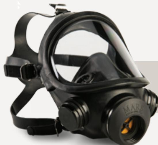
Masque complet très confortable en caoutchouc EPDM antibactérien facile à entretenir. Doté d'un bandeau de tête et de cou réglable afin de permettre un ajustement précis du masque. La visière est en polycarbonate et procure dès lors une bonne résistance à l'impact. Peut être combiné avec les filtres Uranus, mais aussi tous les autres filtres à visser DIN.
